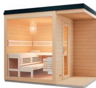
Abb. Gartensauna CASA 3 mit Sonderausstattung: Attika aus Blech in Anthrazit, selbstklebende Dachbahn „BYTUM SLATE 3500“ mit Schieferbeschichtung, Regenrinne mit Ablauf, Saunasteuerung T innenliegend, Saunaofen Ferro.
